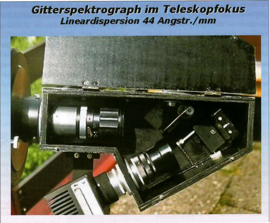
Abb. 2: Einblick in den geöffneten Gitterspektrographen, f_{\text{Kollimator}} = 135 mm, f_{\text{Image}} = 135 mm; Gitter 50 · 50 mm, 1.200 Linien/mm.
