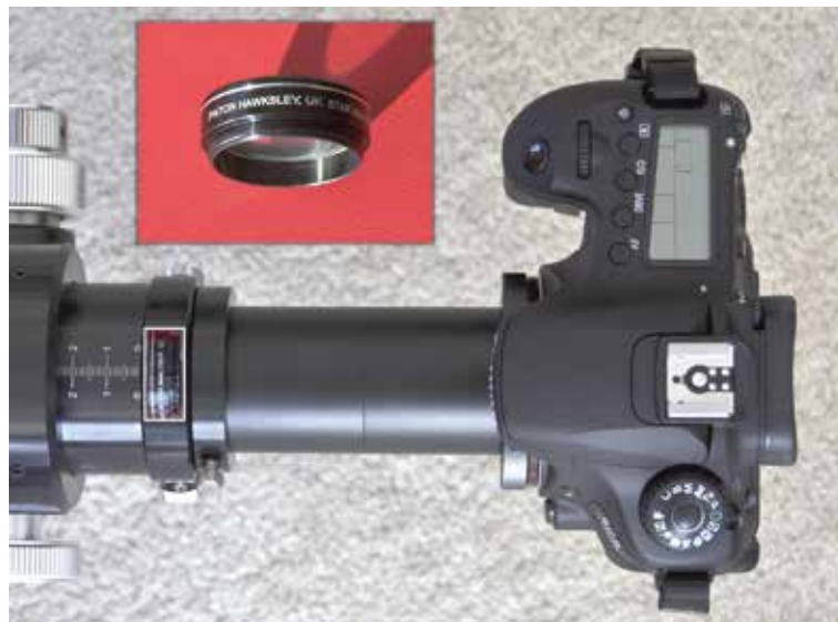
Instrumenteller Aufbau des Spektrografen mit Okularauszug, Verbindungsadapter mit eingesetztem Gitter, Distanzhülse und DSLR-Kamera. Die Position des Gitters ist eingezeichnet (roter Rahmen). Die Distanz Gitter – Sensor beträgt 155 mm.
